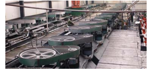
石墨矿浮选 Graphite Flotation Separation
