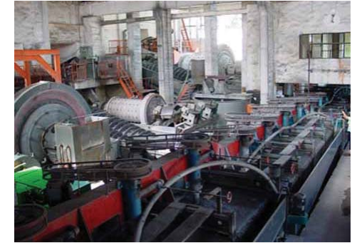
石墨矿浮选 Graphite Flotation Separation
